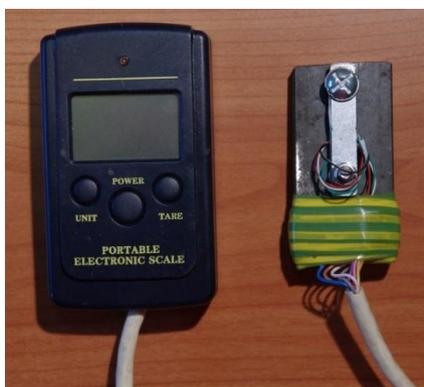
**2 - Seconde version du prototype : capteur intégré.** Utilisé avec succès pendant une année complète
