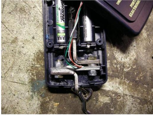
**6 Retirer le capteur d'origine composé des trois pièces en métal fixées par deux boulons.**
